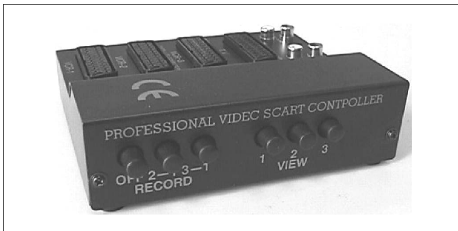
Figura 1.6 Se vengono utilizzate più sorgenti video, è utile munirsi di un commutatore come questo, in grado di accogliere i cavi SCART di tre apparecchi e di selezionare quello da utilizzare semplicemente premendo un pulsante: in questo modo si evita di collegare e scollegare cavi.
