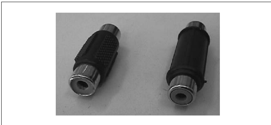
Figura 1.13 Spesso sono necessari adattatori di questo tipo o anche, in alcune configurazioni, adattatori a Y per indirizzare l'audio su due apparecchi diversi.
