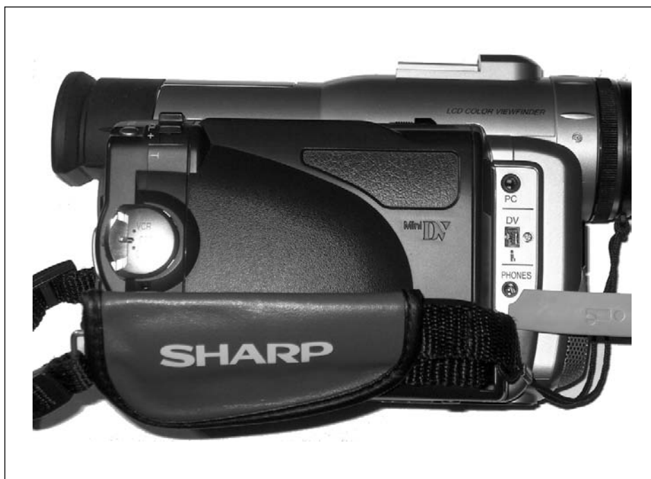
Figura 1.8 Una videocamera DV prodotta da Sharp. Sulla destra è visibile la porta FireWire.
