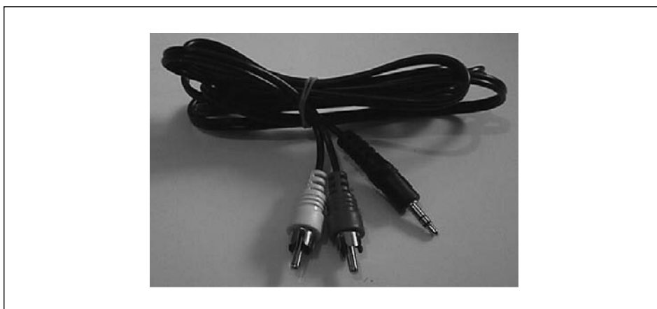
Figura 1.12 I cavi RCA sono spesso in dotazione con la scheda audio o anche con il masterizzatore; ne occorrono due del tipo illustrato nella figura; se si possiedono, si possono comunque trovare facilmente in commercio.
